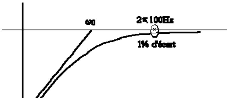
$$\left| \frac{j\omega/\omega_0}{1+j\omega/\omega_0} \right| \geq 0.99 \quad \text{avec } \omega_0 = 2\pi * 100\text{Hz}$$
