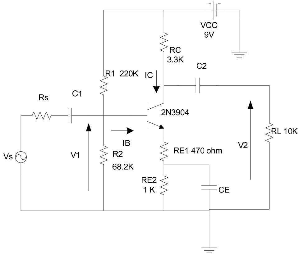
$$V_{cc} = 9 \text{ V} \quad T = 2n3904 \quad (\beta \text{ typique : } 150)$$
